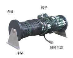
AB330S天线用于短波背负台远距离通信和车载台静中通。 其振子采用强力钢铜复合线材,长18米,宽0.4米,匹配器和负载 设计为超小型一体结构,比轻型三线天线更轻巧,架设快捷,利 用卷轴和支架, 收集非常方便。
