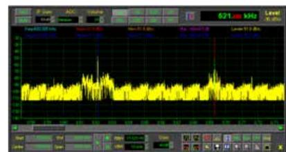
接收机前级基于DDS的双变频超外差，末级中频处理由DSP软件完成，不依赖计算机声卡。由于软件化，减少了元器件，提高了性能和可靠性，而且增加解调或解码方式只需修改软件就可实现。
