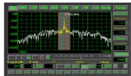
RADIXON（瑞迪新）公司的WR-G31x系列接收机基于软件无线电技术，性价比高，广泛用于军事、安全、通信、广播、无线电管理等领域。
