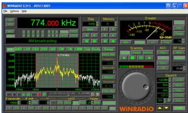
能够记录音频及20kHz宽的中频信号，可以用不同的中频滤波带宽、陷波滤波器、噪声抑制或解调设置反复“再接收”同一信号，从而最大程度优化弱信号或受干扰的信号接收效果。
